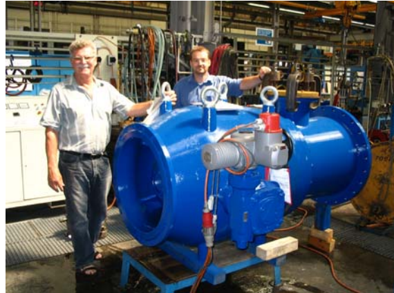
Abb. 11: Endabnahme der Grundablassarmatur (Ringkolbenventil) im VAG-Werk Mannheim (2006)
