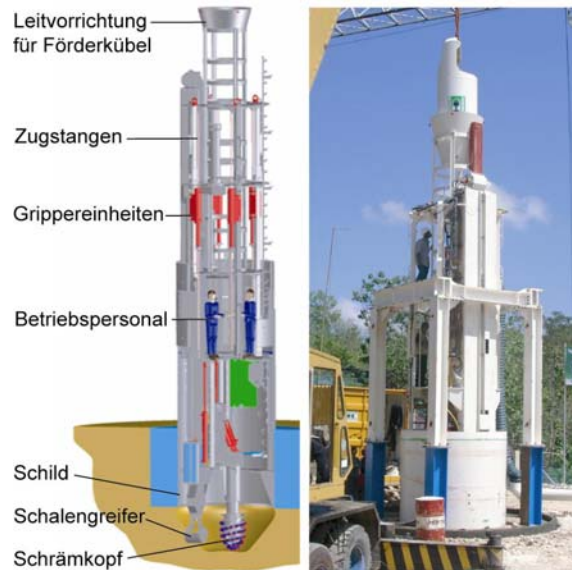
Abb. 8: Schachtabsenkanlage der Herrenknecht AG [4]
