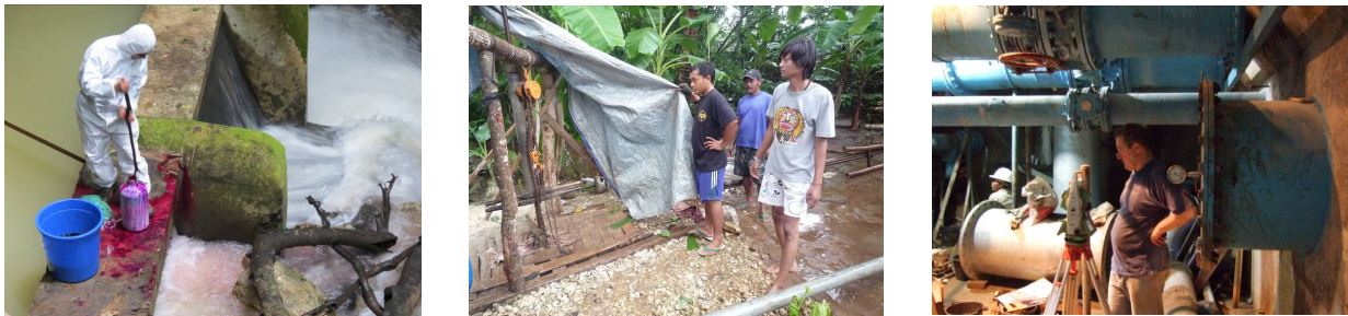
Abbildung 2: Tracereingabe (links), Abteufen einer Probebohrung (Mitte), tachymetrische Vermessungen der Anlage Bribin (rechts)
