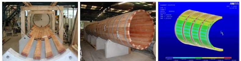
Montagezustand einer Druckrohrleitung aus Holz (links); Versuchsstand zur Untersuchung von aufgelagerten Druckrohrleitungen (Mitte); Ergebnisse einer Computersimulation (FEM) (rechts)
