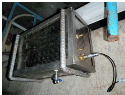
Abbildung 7: Steuerungseinheit des Kontroll-Systems für halbautomatischen Betrieb (links), Mess-Container für Sickerwasser (Mitte), Messsensorik auf der Anlagenplattform (rechts)
