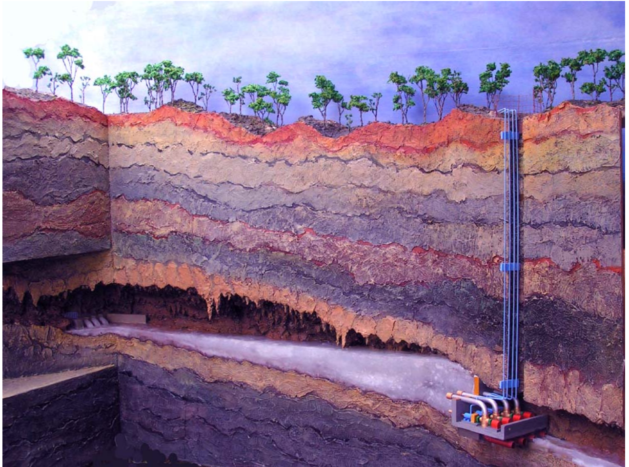
Variante 1: Partieller Einstau des Höhlensystems mit einem Sperrbauwerk mit integrierter Kleinwasserkraftanlage
